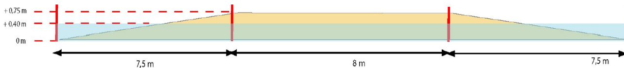
Profil sur la largeur (en gris, le profil de l'îlot dans son état initial et en bleu le niveau d'eau attendu durant la saison de nidification)
