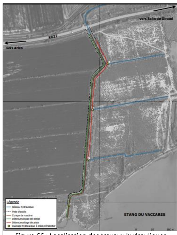
Figure 66 : Localisation des travaux hydrauliques d'optimisation des apports en eau douce au Vaccarès via Mas neuf
